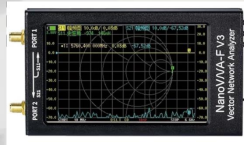
NanoVNA per uso amatoriale 100KHz – 2GHz Costo circa 100 €
